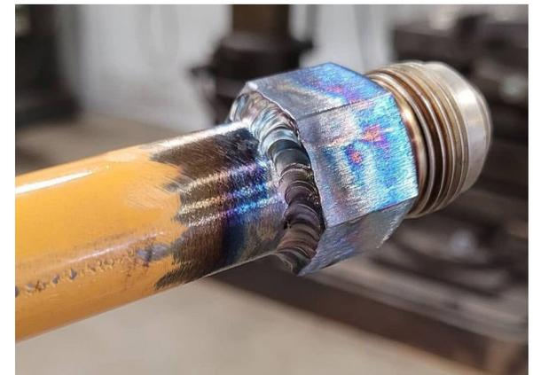
Tartan TIG se utilizó para realizar esta soldadura impecable en una aplicación hidráulica de alta presión.
