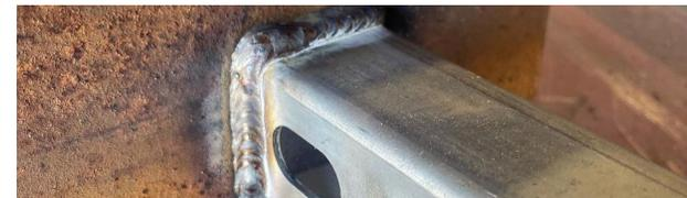
Soldadura de acero galvanizado a acero oxidado utilizando Tartan B MIG
