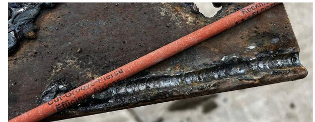
La varilla de ranurado sin aire Electra AAA es una forma rápida de eliminar una soldadura.
