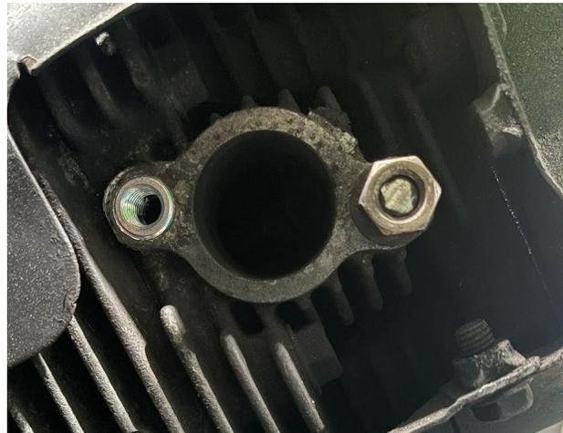
Reparación de rosca pelada en un barreno de escape utilizando un inserto roscado.
