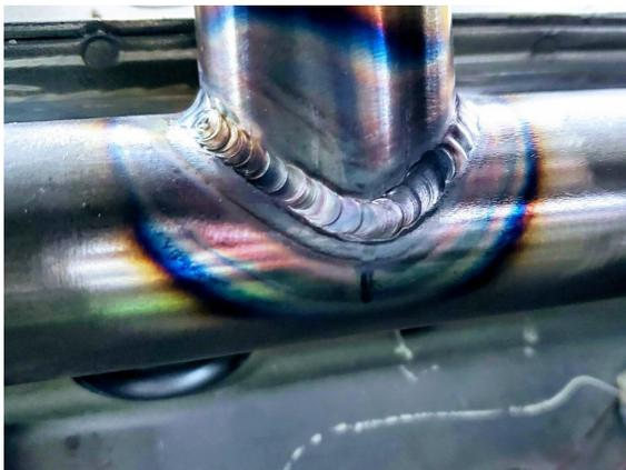
Brutus TIG utilizado aquí para construir una jaula antivuelco de acero al cromo-molibdeno. Brutus puede soldar cualquier acero.
